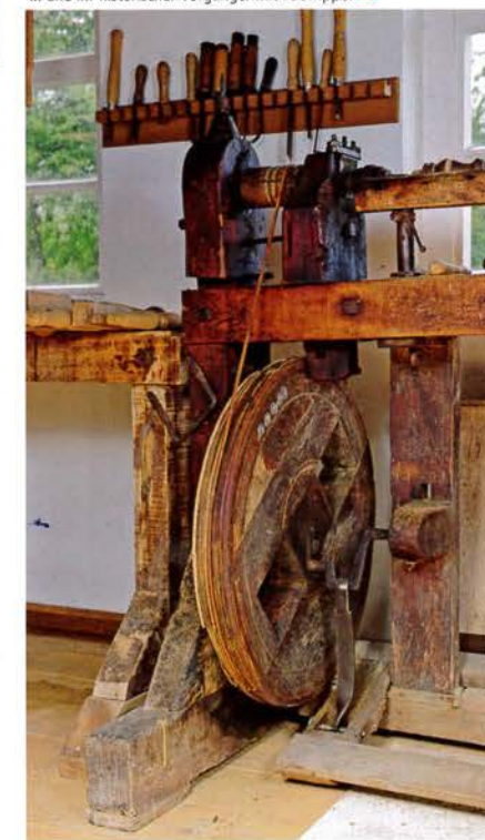
▲ „Moderne“ Drehbank um 1920 mit Transmissionsantrieb ... ... und ihr historischer Vorgänger mit Fußwippe. ▼
