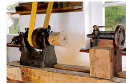
▲ „Moderne“ Drehbank um 1920 mit Transmissionsantrieb ... ... und ihr historischer Vorgänger mit Fußwippe. ▼
